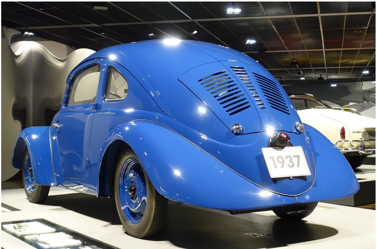
Dieser Porsche hat noch kein Heckfenster. Zwischen dem Heckmotor und dem Fahrerraum hat es eine Scheibe. Durch diese sieht man durch den Motorenraum und die Luftschlitze nach hinten. Der VW Käfer war ja mit seiner Luftkühlung nie berühmt in Sachen Lärmschutz. Dieses Konzept war vermutlich nur mit Gehörschutz zu bewältigen.
