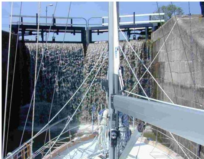
Schiffe geschleust sind. Das aufwärts Schleusen ist anstrengend und erfordert einen ständigen Einsatz. Da das Wasser im Gegensatz zu modernen Schleusen nicht von unten, sondern ganz vorne durch das Schleusentor mit grosser Wucht einströmt, muss man das Schiff über die Winschen halten und ständig korrigieren.
