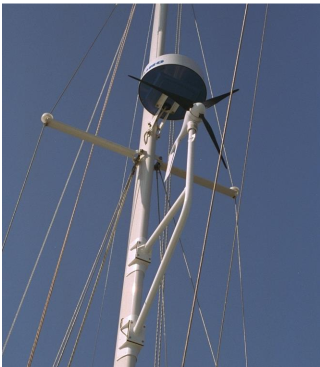
Der neue Windgenerator
