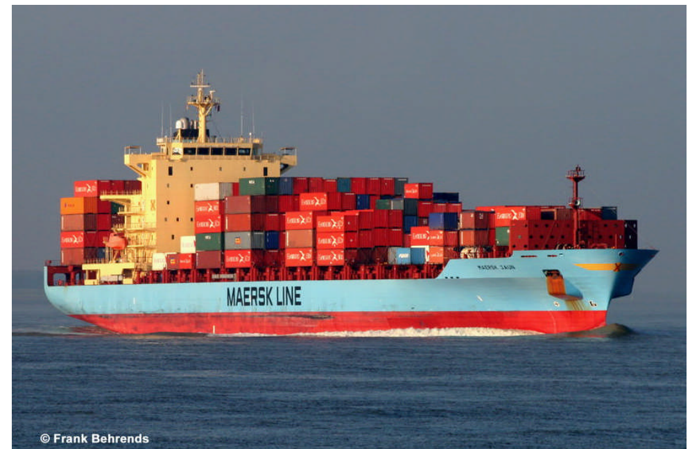
Die MAERSK JUAN, Baujahr 2005, ein Containerschiff mit 2824 TEU (Twenty-foot Equivalent Unit). Dies ist das Mass der Ladekapazität. Sie kann also 2824 Standardcontainer von rund 6 Metern Länge laden 17 .
